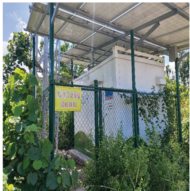
Trạm quan trắc không khí tự động liên tục tại ấp Cồn Cù, xã Đông Hải, huyện Duyên Hải
